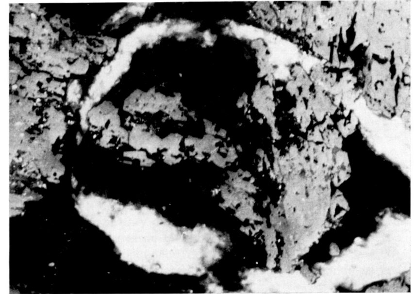
Figura 6.21.—Magnetita de recrystalización invadiendo a un oolito de cuarzo (blanco) en las zonas más internas de la aureola de metamorfismo. El núcleo del oolito es de clorita. N. C. \times 310
