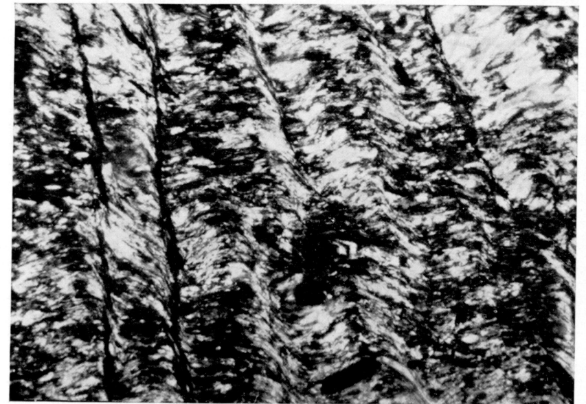
Figura 6.4.—Aspecto al microscopio de un micaesquisto. N. C. \times 6,5
